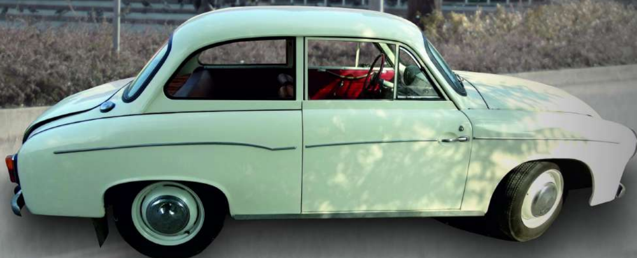
FSM Syrena 104 (Polska) Rok: 1970 Silnik dwusuwowy, trzycylindrowy Pojemność: 842 cm, moc 29 kW
