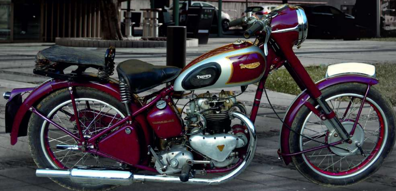
Triumph 3T (Anglia) Rok: 1947 Silnik dwusuwowy Pojemność: 349 cm, moc: 19 kW
